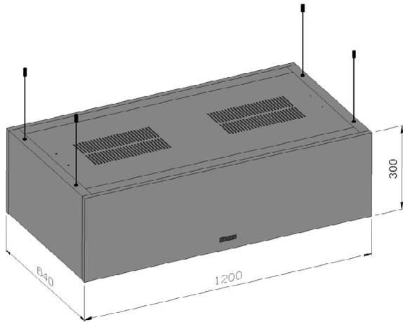
**Campana extractora i-BOX para islas de cocina 120 cm de ancho, 64 cm de profundidad, 30 cm de altura, de acero cromo-níquel 1.4301, valor de conexión 145 vatios, con filtro de convección Plasma**
